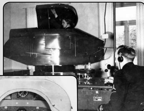
Exteriör- och interiörbild av Linktrainer med elev och lärare på plats.
