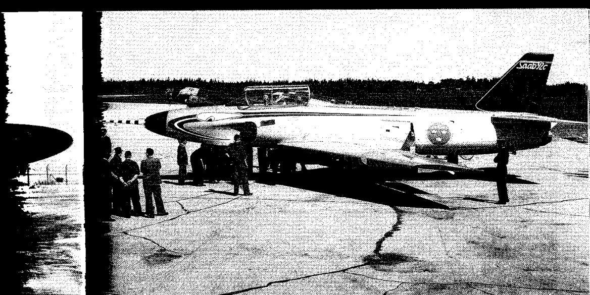
S 32C (32901) utrustad med SKa 18 och fotobomber på besök på F 11. Detta var den enda S 32C som aldrig baserades på F 11. Notera den förändrade märkningen på fenan jämfört med föregående bild. Foto F11.
