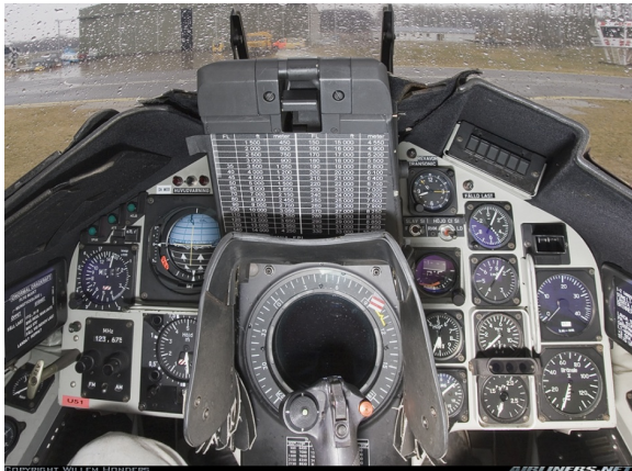
Instrumentpanelen i SH37. En ny dataindikator har tillkommit i blickfånget överst på höger sida.
