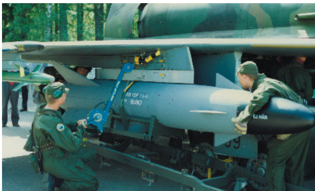
Hängning av RB 15 på vägbas. Foto: Åke Andersson
