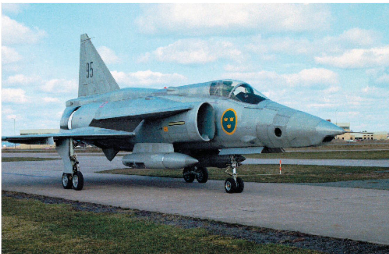
Prototypen till SF 37. Detta flygplan var från början en AJ 37, 37033, som byggdes om till fotospaningsversion. Foto: Saab
