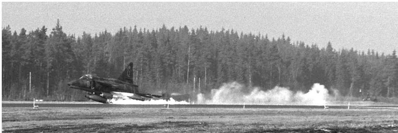
Fänrik Anders Ryttberg buklandar med SF 37, 37961 (F 13-12), på banan på F 17 den 6 februari 1990 efter fågelkollision. Skador på länksystemet gjorde att landstället inte kunde fällas ut. Extratanken och motmedelskapslarna tog "smällen" och planet reparerades och kom senare till F 21. Se även bild på sid 124. Foto Gösta Bolander.
