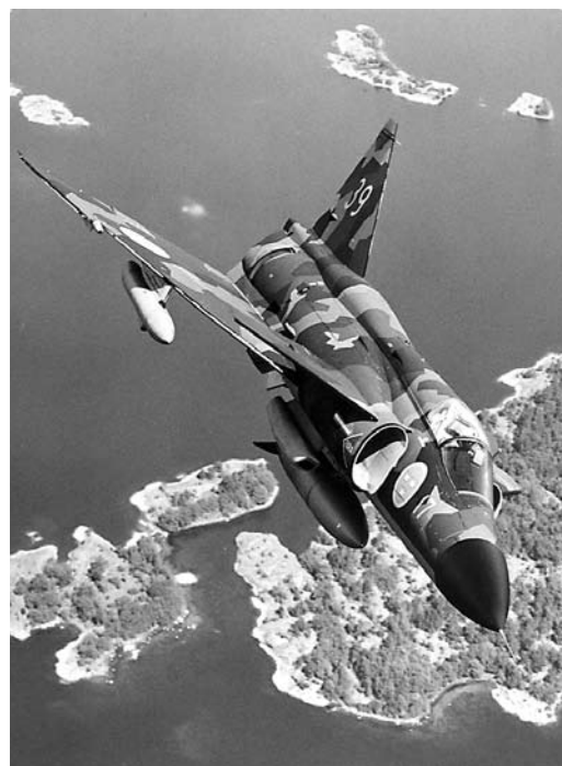
SH37 (37902) från Quintus Blå med motmedelskapslar, avståndskamerakapsel och extratank. Foto Inge- mar Thuresson, SAAB-
