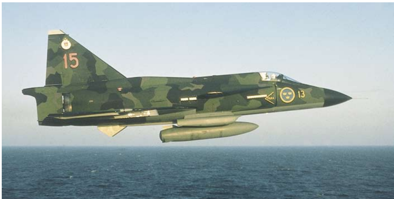
SH37, F 13-15, på låg höjd över Östersjön. Utöver extratanken utgörs den yttre utrustningen endast av avståndskamerakapseln på höger sidobalk. Foto
