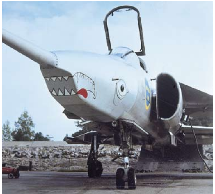
Ovan: Med hjälp av en plåt nos (utan kameraöppningar) provades de aerodynamiska egenskaperna på SF 37:s kameranos med 37 -1. En liknande målning gjorde även på SF 37 från F 13 och F 21. T v: Kamerainstallationerna i SF 37 tog upp större delen av nospartiet. Foto Sven Stridsberg.
