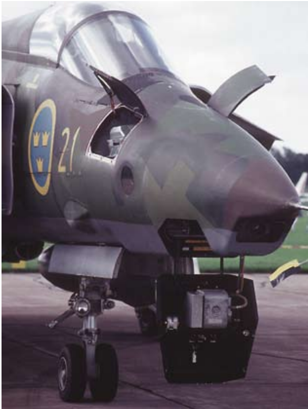
Ovan: Med hjälp av en plåt nos (utan kameraöppningar) provades de aerodynamiska egenskaperna på SF 37:s kameranos med 37 -1. En liknande målning gjorde även på SF 37 från F 13 och F 21. T v: Kamerainstallationerna i SF 37 tog upp större delen av nospartiet. Foto Sven Stridsberg.
