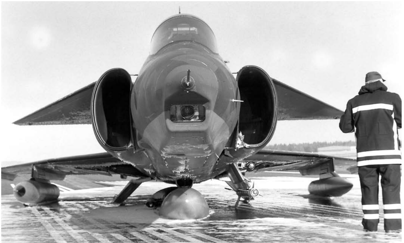
SF 37, F 13-12 ( 37961), efter buklandning på banan på F 17 den 6 februari 1990 efter fågelkollision. Skador på länksystemet gjorde att landstället inte kunde fällas ut. Lägga märke till kamerasiktet i flygkroppen på nosens högra sida (sett i färdriktningen). Se även bilderna på sidorna 119 och 227. Extratanken och motmedelskapslarna tog "smällen" och planet reparerades och kom senare till F 21. Foto Gösta
