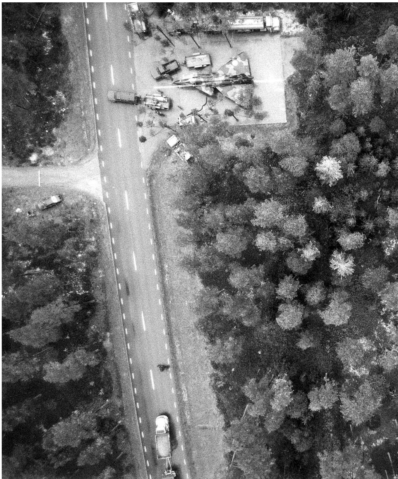
Flygbild tagen av SF 37 med SKA 24 under lågflygning över delvis kamouflerad klargöringsplats på en landsväg. Man kan se pågående hängning av robotarna Rb 05 och Rb 24. Bränslepåfyllningen är redan avklarad och tankbilen skymtar strax utanför plattan i bildens ovankant. Längst ner på bilden har en grusbil (och annan trafik) stoppats då attackplanet snart skall taxa ut för ett nytt uppdrag. Foto Flygvapnet.
