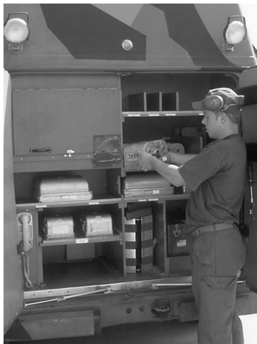
Värnpliktig fototekniker lägger in SKA 24-magasin i fotobussen för vidare transport till fotovagnen för framkallning och analys. Samtidigt ersätts de urtagna kameramagasinen med nya, laddade med film. Foto Sven Stridsberg.
