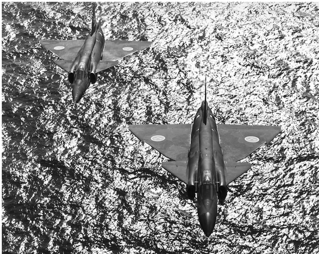
Spaningsviggen flög ofta rotevis över hav med en SF 37 och en SH 37. SH 37 kunde med sin radar lokalisera sjömålet och kamerautrustningen i SF 37 kompletterade avståndskameran i SH 37. Planet t v är en SF 37 (F 17-64) och t h en SH 37 (F 17-53). Foto Boris Erixson.
