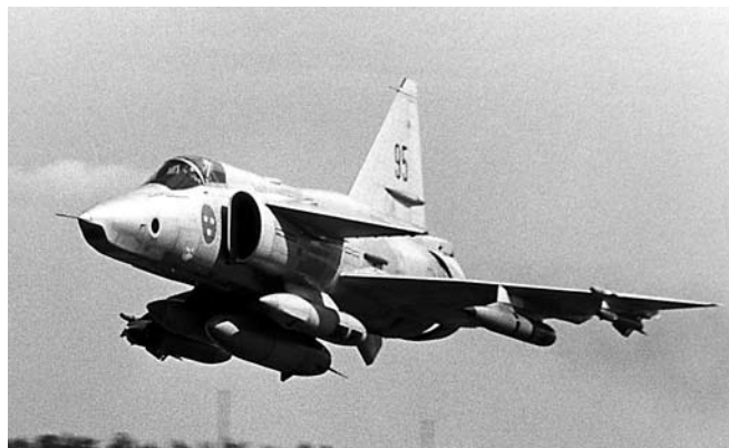
Prototypen till SF 37, SAAB -95 (37950), utrustad med mörkerspaningsskapslar och störcapslar, samt två Rb 28 Falcon på robotbalkarna. Foto N-G Widh, Saab-Scania.
