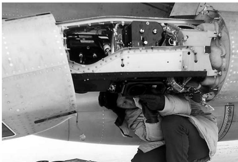
Mörkerspaningskapseln med framförd noskon för service av kameror.
