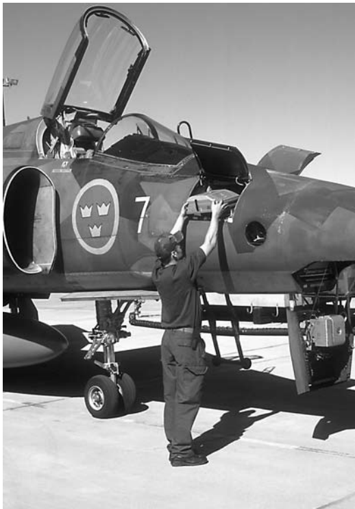
T v: Byte av magasin till den högra höghöjds/avstånds-kameran SKA 31 på en AJSF 37 på Urban Röd (F 21). Flygplanet bär flottilsiffran 7 trots hemhörighet på F 21. T v om kamerateknikern skymtar "bulan" med kamerasiktet och t h är öppningen till höger låghöjdskamera SKA 24C. Foto Sven Stridsberg.
