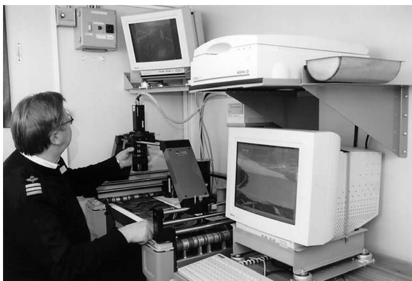
Mittbilden. Framkallning av de långa flygfilmerna i laboratorievagnen. Formatet på SKA 31 var 23 x 23 cm så det var stora filmytor som behandlades. Foto Roland Nordgren.
