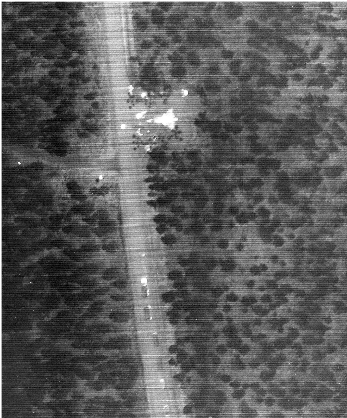
Bild tagen med värmekamran VKA 702 samtidigt som bilden på vänster sida. Här framgår tydligt hur varma föremål som människor, flygplanet (som är varmt sedan landningen strax före), bilmotorer och bildäck (se grusbilen och dess släpvagn) kontrasterar klart mot den kallare (mörkare) omgivningen. Notera att vingarna är något mörkare än flygkroppen, då den senare värmts av motorn och vingarna kylts av det nypåfyllda bränslet. Foto Flygvapnet.
