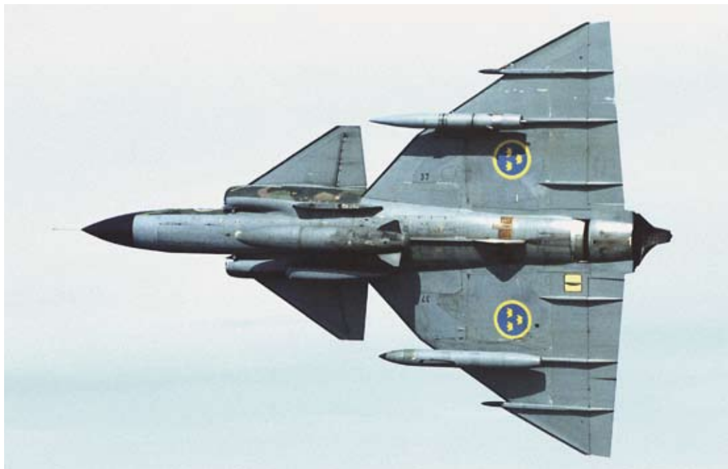
SH 37 med störcapslarna KA och KB på vingbalkarna samt avståndskameran SKA 24D på höger sidobalk. På centralbalken hänger (som vanligt) extratanken. Foto Gösta Bolander, F 17.
