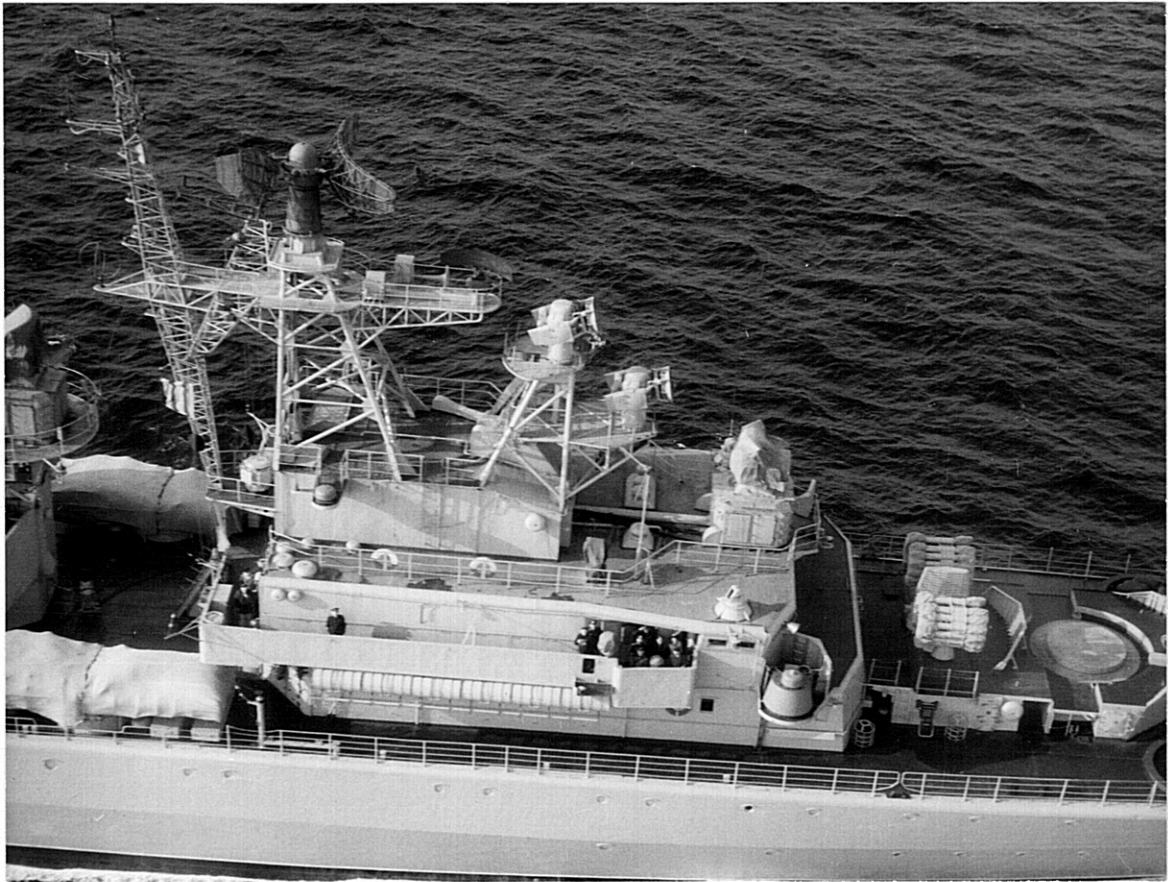
Fig 6. Flygsnedbild av KRIVAKs bryggparti sett i ungefär 90^{\circ} målvinkel (jfr fig 5). För därom märkes de båda AU-raketpjäserna och den täckta lvrbrunnen, längst t v i bilden de båda kvadruppeltubställen för 53 cm torpeder, dolda av kapell.
