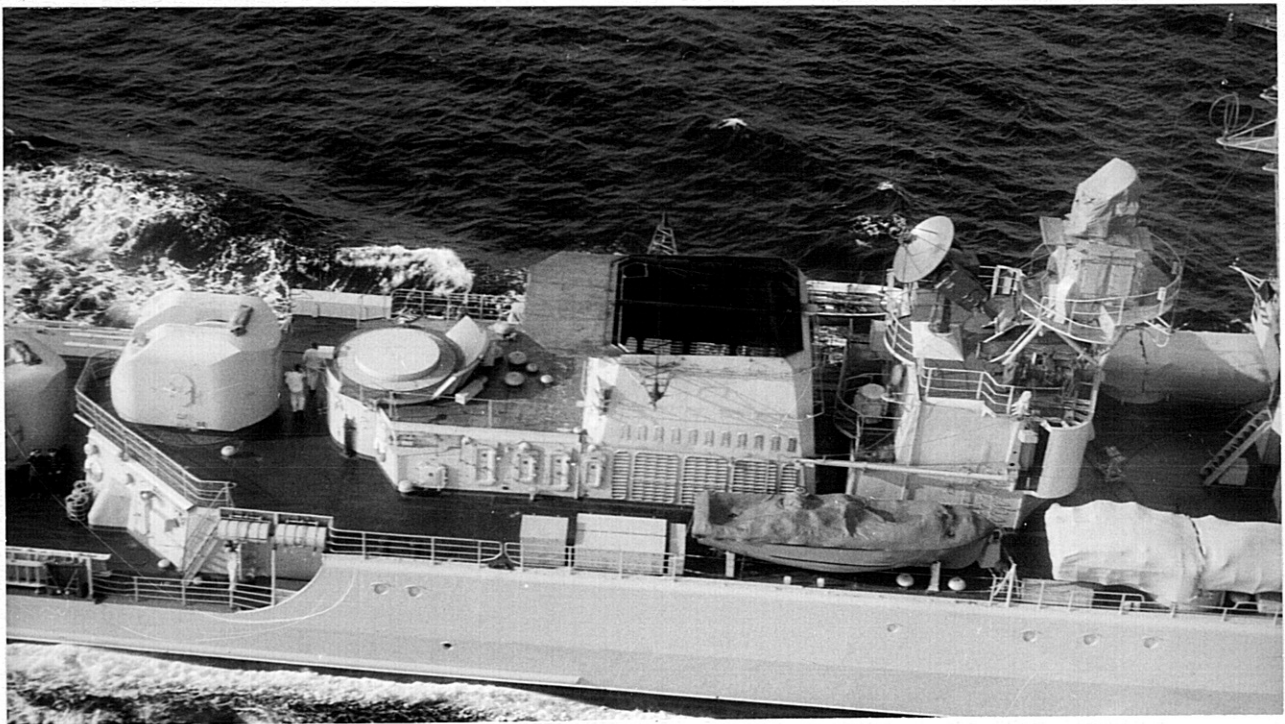
Fig 3. KRIVAK-jagarens aktra midskeppsparti fotograferat strax efter exponeringen av bilden i fig 2 ovan. Aktra lvrb-lavettaget är i nedsänkt läge och brunnen helt täckt. Skorstenen är konstruerad som avgaskanal med ejektorverkan varigenom kylluft sugas in (genom i skorstenssidorna upptagna galleröppningar) och blandas med avgaserna. Härigenom minskas IR-strålningen, och avgaserna få en låg profil.
