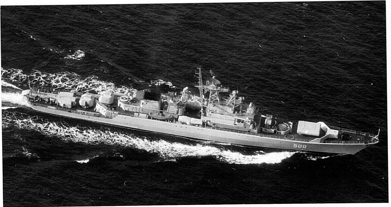
Fig 2. Flygsnedbild av robotjagaren "500" av KRIVAK-klass under gång med ca 20 knops fart. Aktra lvrobotlavettaget har varit i höjt läge och är på nedgående - blott översta toppdelen skymtar ännu i den delvis öppna brunnen. VDS-anläggningens släpkropp är utlagd (se även fig 7 och 8).
