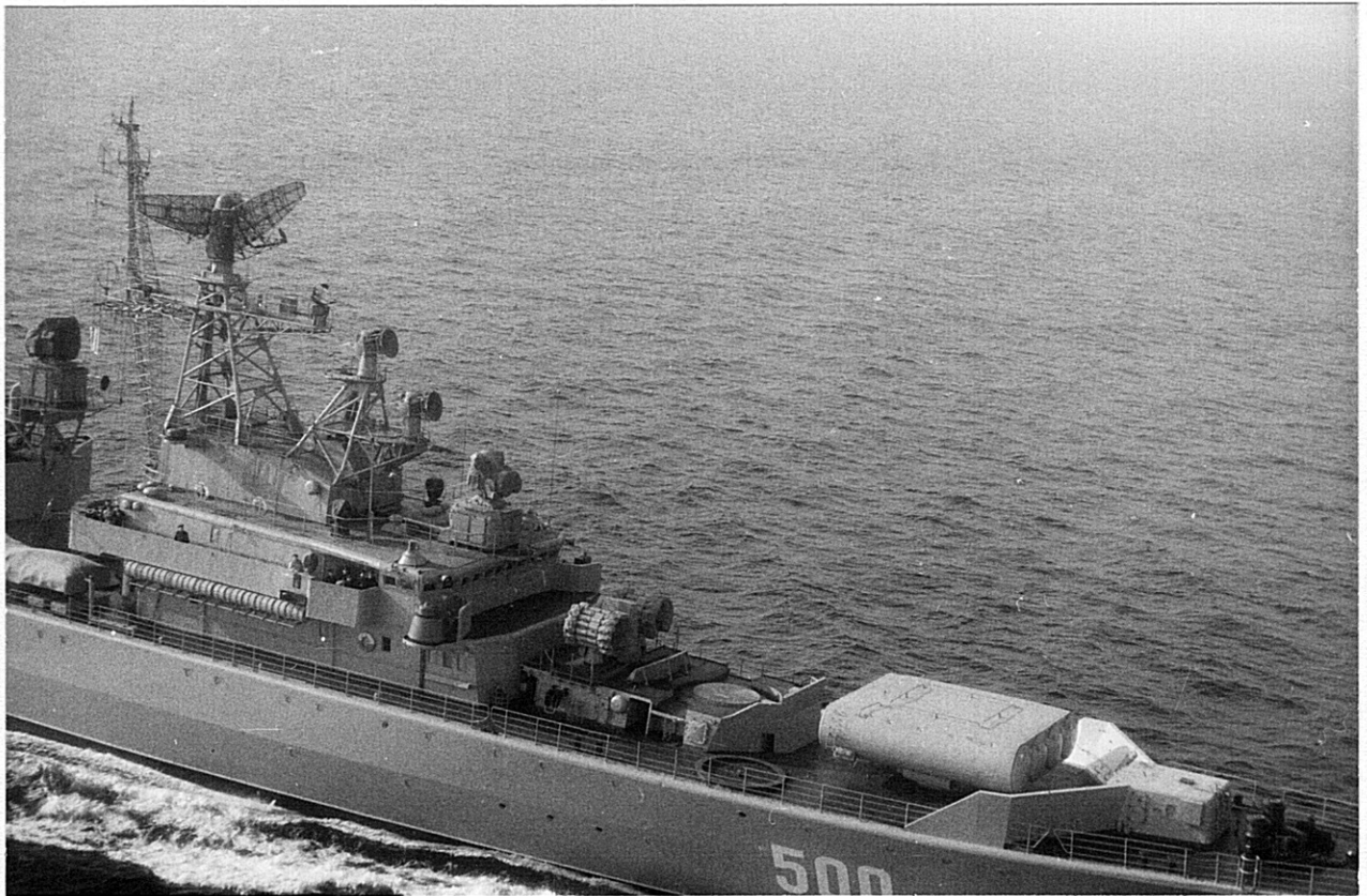
Fig 5. KRIVAK-jagarens förskepp fotograferat från styrbords bog. På fördäck dominerar sjrb-lavettet med 4 tuber sannolikt för SS-N-10. Akter därom märkes det cirkelrunda "taket" över den förliga lvrbrunnen, där efter 2 st AU-raketpjäser typ MBU 2500 A och i ABCD-liknande uppställning över bryggpartiet och på mastplattformar en ny eldledningsradar för lvrbr, ny styrningsradar för sjrb (2 st), navigeringsradar typ DON KAY och spaningsradar typ HEAD NET C.
