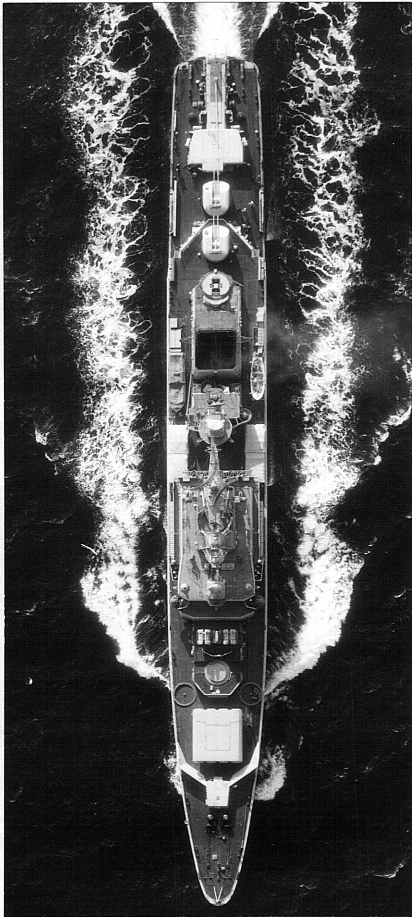
Fig 1. Lodbild av robotjagaren "500" av KRIVAK-klass under gång med 20 knops fart. Det aktra höj- och sänkbara lvrobotlavettaget har just sänkts, men täckluckorna ha endast delvis hunnit tillslutas. Brunnen för det förliga lvrb-lavettaget är däremot helt täckt. Sjörobotlavettaget, i baksuppställning, är svängt längskepps, liksom torpedtubställen midskepps bordvarts och 75 mm torndubbellavettagen i XY-uppställning akter om aktra lvrb-lavettaget.
